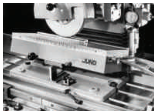
Figura 7 – Fixação em mesa de seno magnética.
