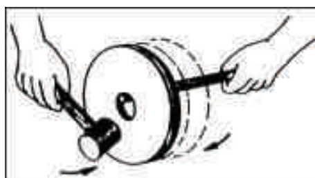
Figura 3 – Teste de fissuras.
